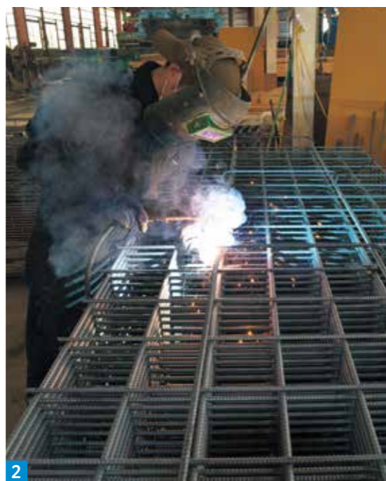
① 一沢コンクリート工業(株)宇部工場 ② 製品内部に使われる鉄筋の溶接加工が賀口さんの仕事。溶接技術を持つ賀口さんの配属により宇部工場でも鉄筋加工が可能になり、他工場からの配送費が削減されています
